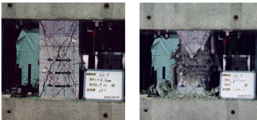
写真2-1 短柱のせん断ひび割れ(右)と破壊(左)
