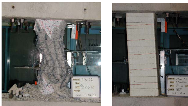
写真5 鉄筋（鉄骨）コンクリート柱（左）は、変形すると崩壊するが包帯補強（右）すれば、潰れない
