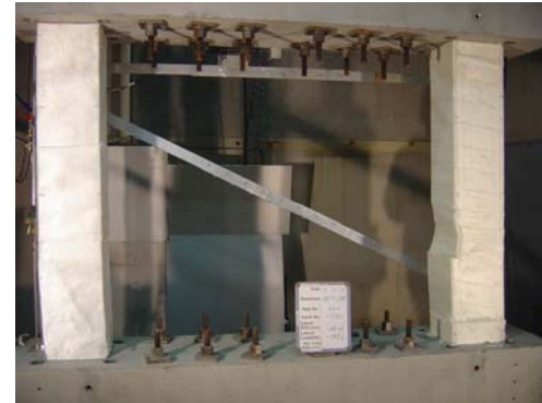
応急補強実験最大耐力時(R=-1/50)
