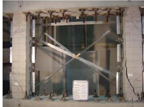
フレーム実験終了（柱脚部せん断破壊）
